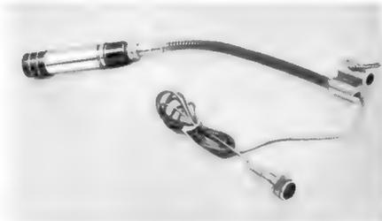
Bild 15. Peiker-Mikrofon PM 3 auf dem selbstgefertigten Schwanenhals
