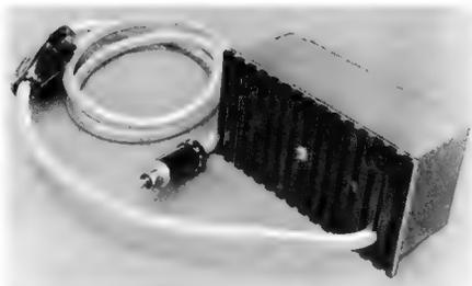
Bild 14. Transistor-Leistungsverstärker für das Butoba-Tonbandgerät MT 5 S
