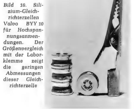
Bild 10. Silizium-Gleichrichterzellen Valvo BY 10 für Hochspannungsanwendungen. Der Größenvergleich mit der Laborklemme zeigt die geringen Abmessungen dieser Gleichrichterzelle
